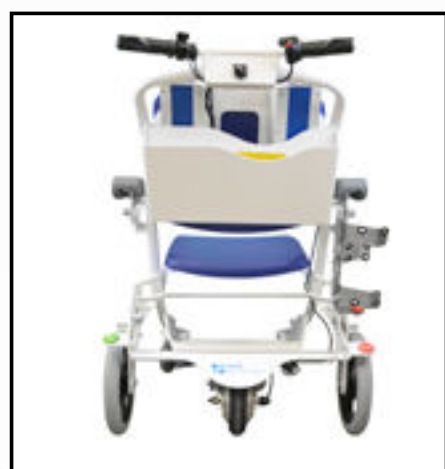
Roue motorisée avec batterie et chargeur intégrés.
