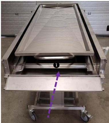
**Intégration de la civière à l'intérieur de la cuve, avec aux extrémités, 1 un panneau basculant pour fermer la cuve et à l'autre extrémité 2 le collecteur extraction d'air.**
